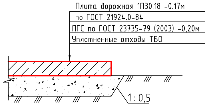
Конструкция дорожного покрытия технологического проезда
