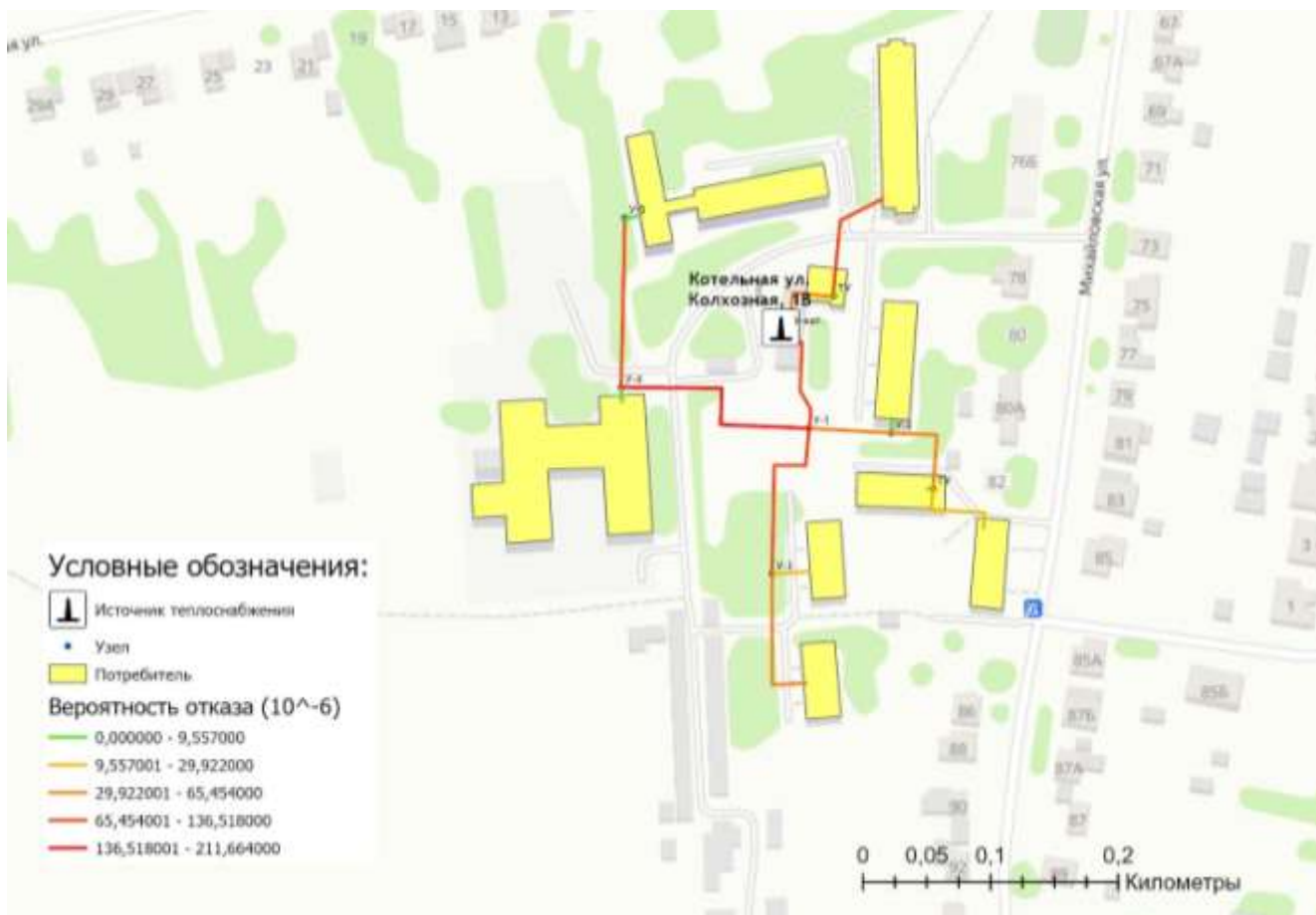
Рисунок 1.9.4.3 - Карта-схемы тепловых сетей и зон ненормативной надежности и безопасности теплоснабжения котельной ул. Колхозная, 1В
