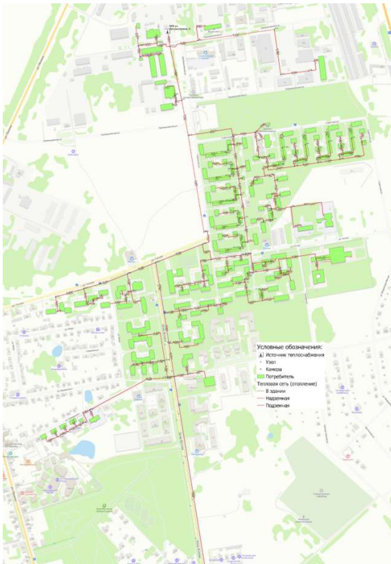
Рисунок 1.3.1.2 - Схема тепловых сетей БМК-16 МВт ул. Промышленная, 6
