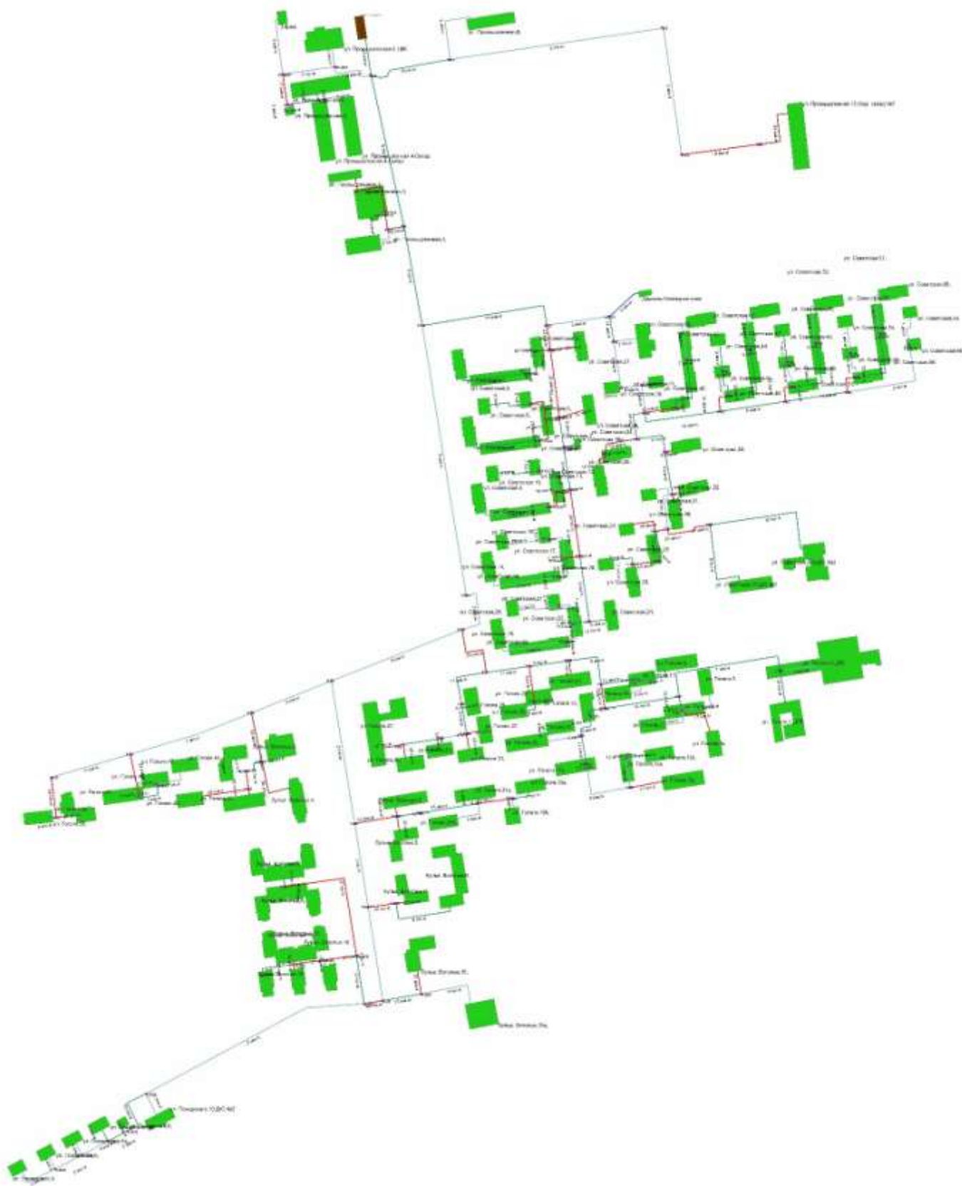
Рисунок 1.6.2.1 - Гидравлические расчеты участков тепловой сети БМК-16 МВт ул. Промышленная, 6
