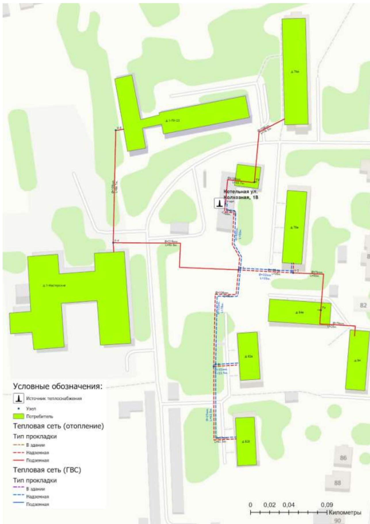
Рисунок 1.3.1.4 - Схема тепловых сетей Котельная ул. Колхозная, 1В
