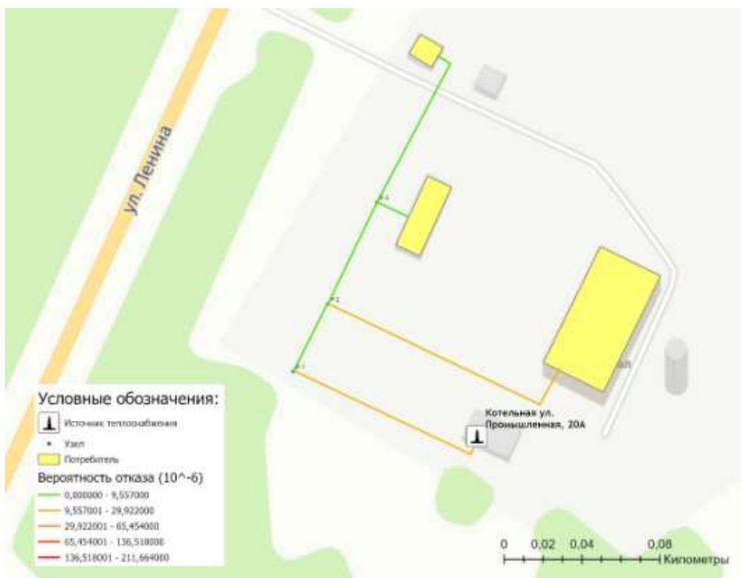
Рисунок 1.9.4.4 - Карта-схемы тепловых сетей и зон ненормативной надежности и безопасности теплоснабжения котельной ул. Промышленная, 20А
