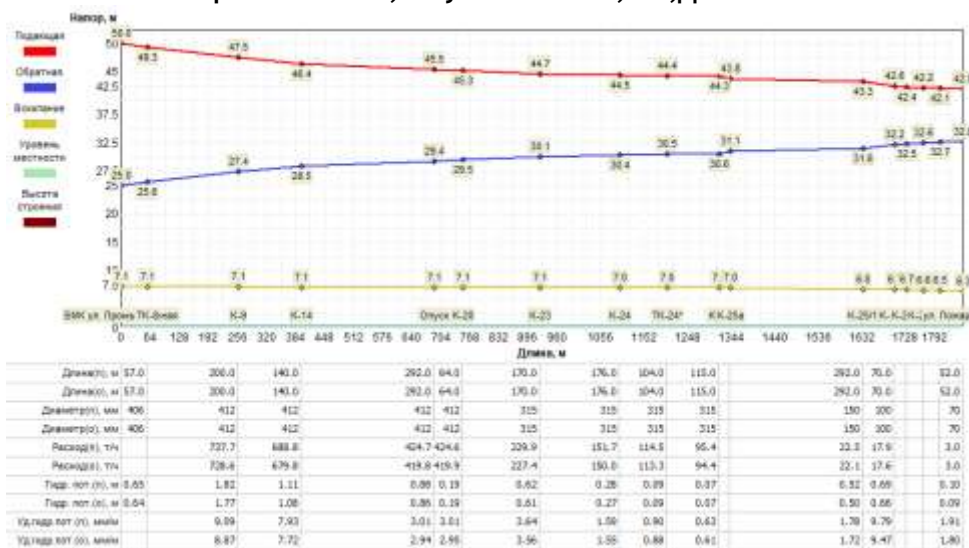
Рисунок 1.3.7.3- Пьезометрический график участка сети БМК-16 МВт ул. Промышленная, 6 - ул. Пожарского,4
