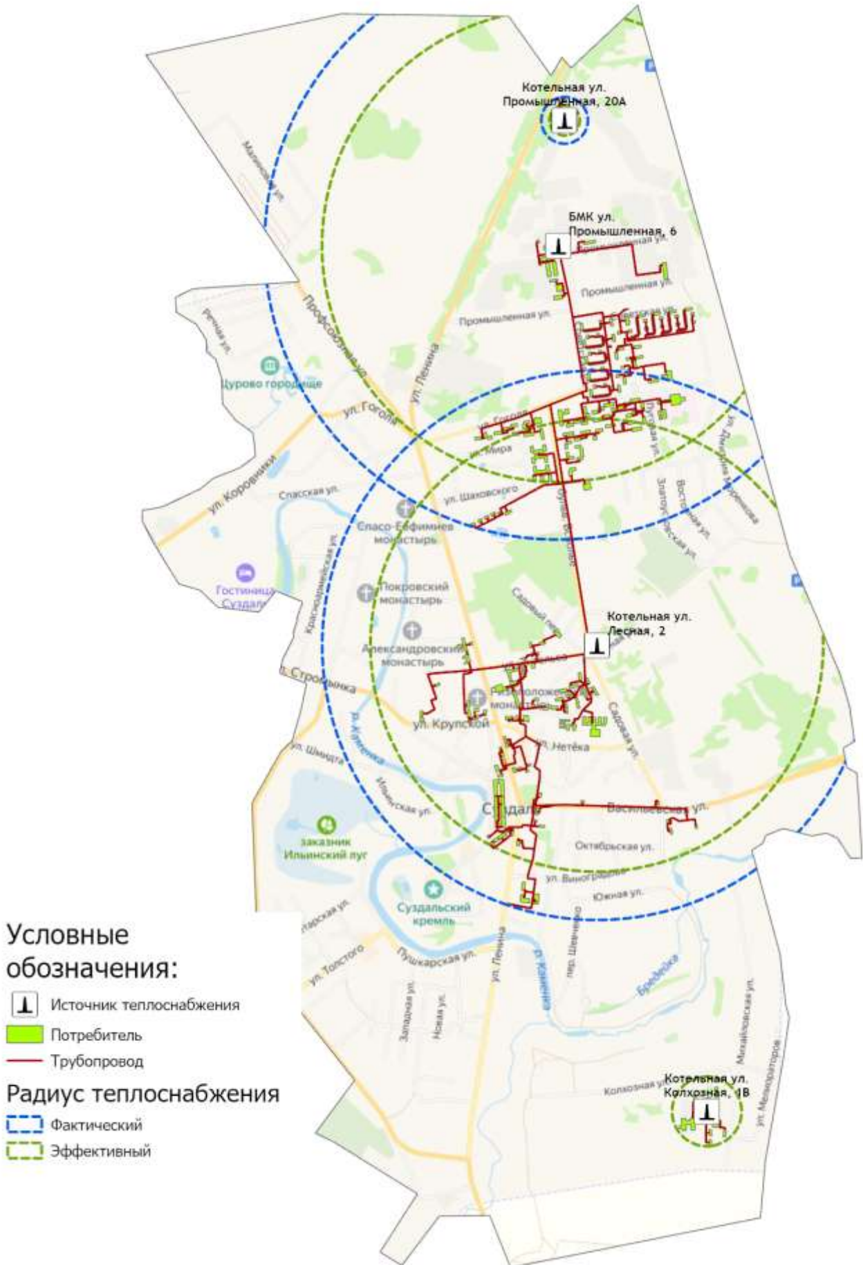
Рисунок 7.15.1 - Радиусы эффективного теплоснабжения котельных г. Суздаль
